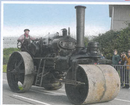
Diese Dampfwalze von Marshall aus dem Baujahr 1925 verdichtete einst nicht nur in England die Straßendecke
