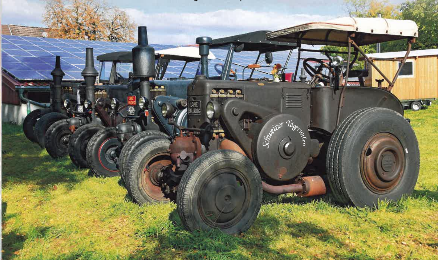
Keiner sieht aus wie der andere: Vorn eine Straßenausführung des Zehn-Liter-Lanz mit nach unten geführtem Auspuff aus der Schweiz.
