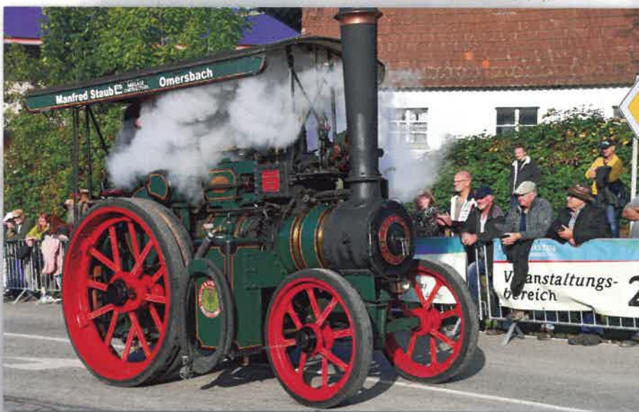
▲ Der kleine Unterschied: Eine Dampfwalze wie die Ruthemeyer namens „Nelly“, wie sie mancher noch kennt, wurde im Straßenbau zur Befestigung der Fahrbahndecke eingesetzt. Der Wallis & Stevens Steam Tractor von Manfred Staub wurde dagegen früher zum Ziehen schwerer Anhänger eingesetzt. ▼
