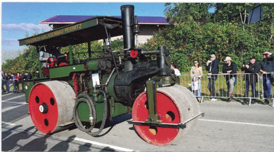
▲ Der kleine Unterschied: Eine Dampfwalze wie die Ruthemeyer namens „Nelly“, wie sie mancher noch kennt, wurde im Straßenbau zur Befestigung der Fahrbahndecke eingesetzt. Der Wallis & Stevens Steam Tractor von Manfred Staub wurde dagegen früher zum Ziehen schwerer Anhänger eingesetzt. ▼
