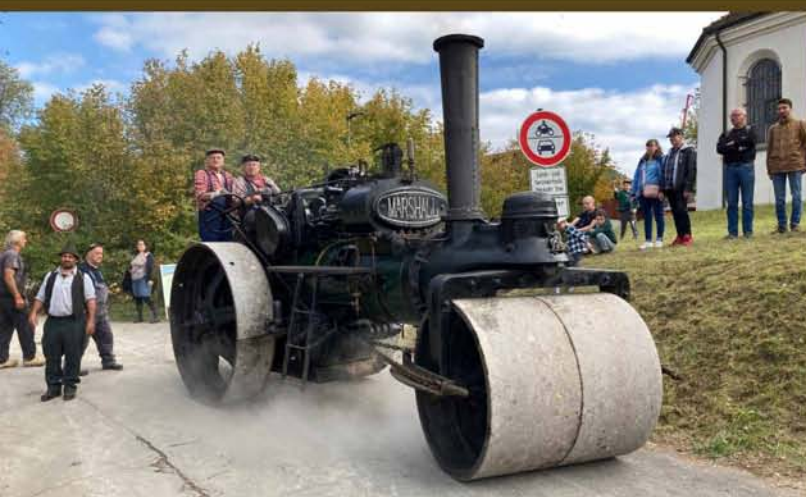
12-Tonnen-Dampfwalze Marshall Typ S gebaut 1925 bei Marshall & Sons in Gainsborough (GB)
